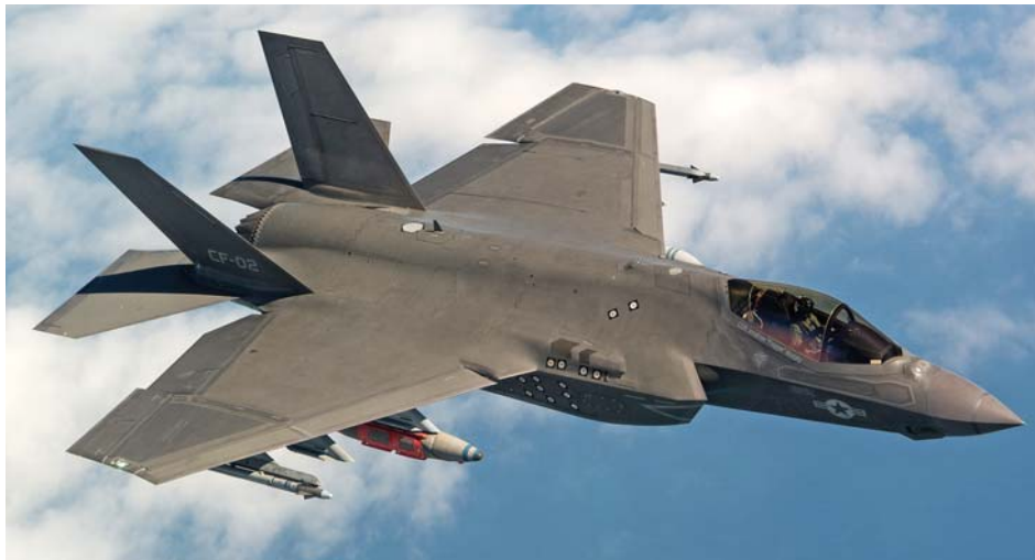
בטיסת הניסוי האחרונה נאספו נתוני עומסים על F-35C עם פצצות GBU-31 וטילי AIM-9X.
